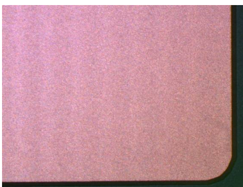
Abb. 11: sauber Cu Oberfläche/ erlaubt
